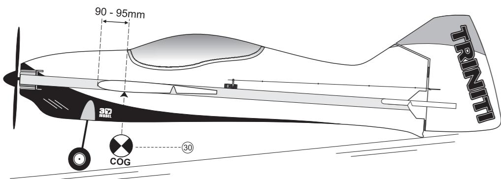
**• Těžistě modelu 30, ideální balanční bod, se nachází 95mm od náběžné hrany křídla. Ve vyznačeném místě model podepřete, a pozici baterii odláďte těžistě. Pokud se model nakloní dopředu baterii umístěte více dozadu, v opačném případě dopředu. Baterii umístěte do trupu, viz nákres č.18 a nebo baterii připevněte na bok trupu pomocí suchého zipu. Nikdy nezkoušejte litat s nevyváženým modelem!**
